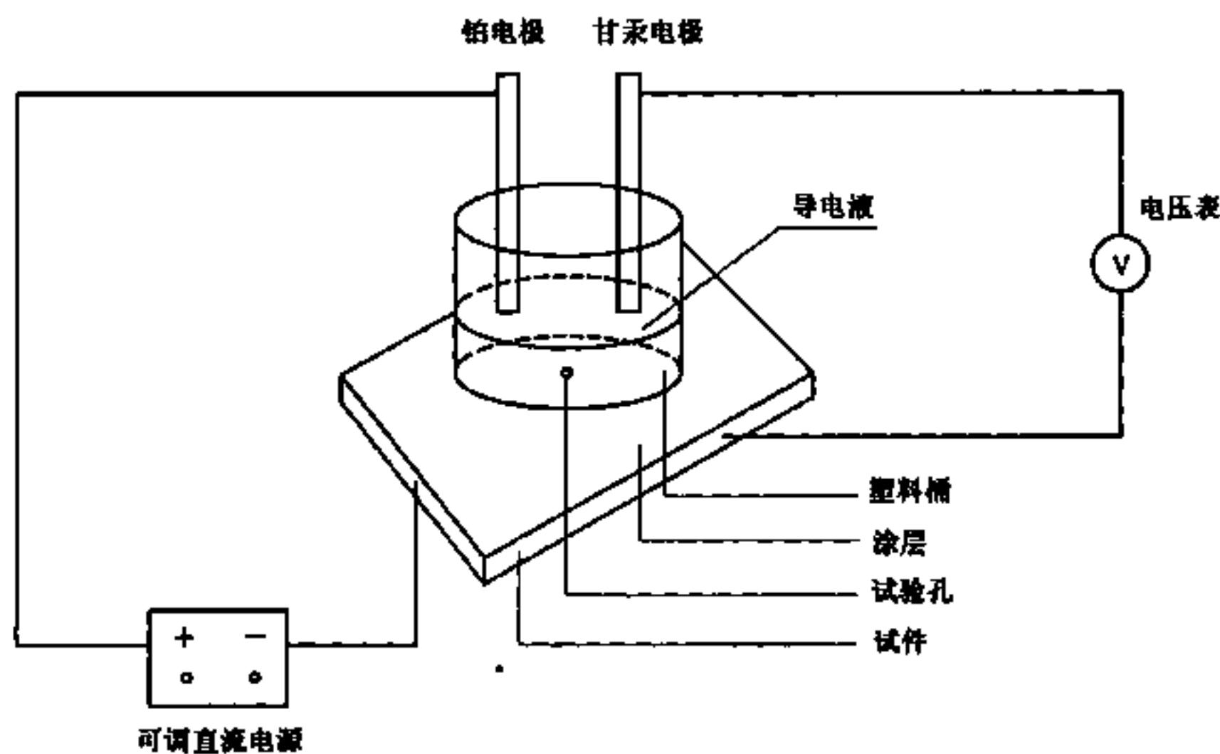
图 D.1 防腐层阴极剥离试验示意图
