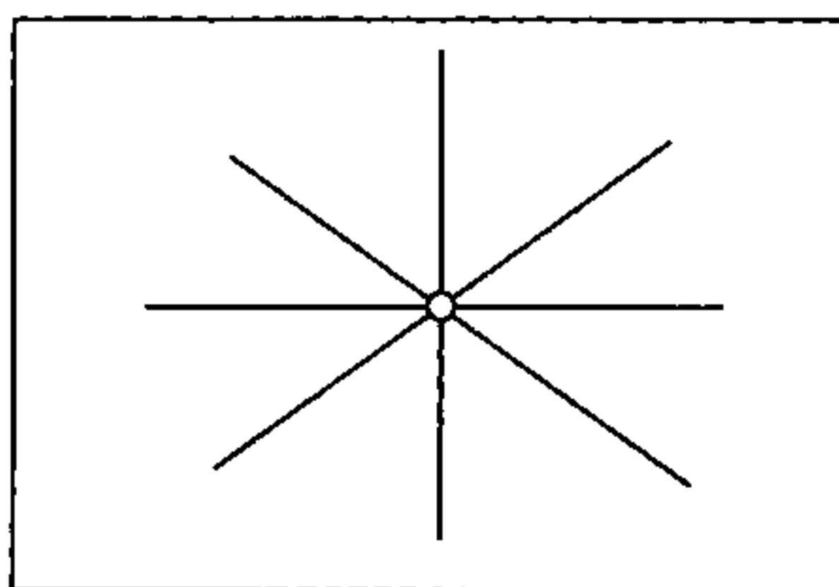
图 D.2 在试件上划透涂层的放射线
