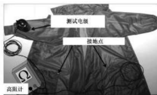
图 A.1 具有接地点的防静电服点对点电阻测试示意图
